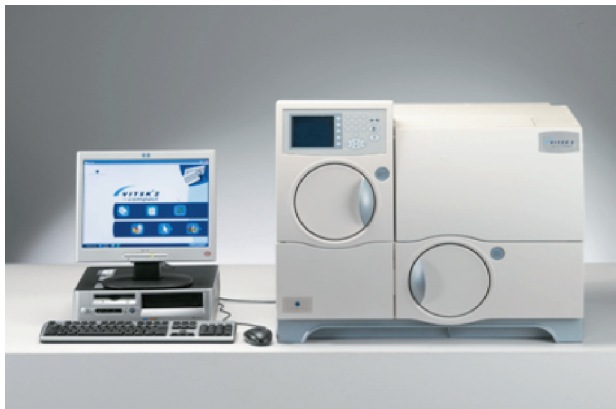
Gambar 1. Alat VITEK2 untuk pengenalan (identifikasi), uji kepekaan antibiotika bakteri dan jamur (yeast) 3
